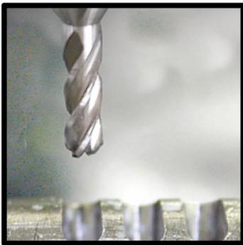
Los cortadores verticales de punta redonda, cuatro gavilanes y corte al centro, están diseñados para usarse en el fresado trazador, asentador de matrices, fresado fileteador y usos donde se requiera una superficie circular cóncava.
