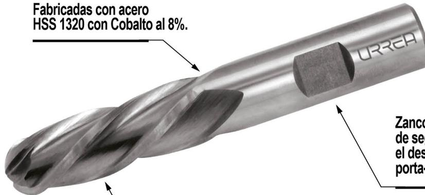
Zanco con muesca de seguridad para evitar el deslizamiento en el porta-herramientas.
